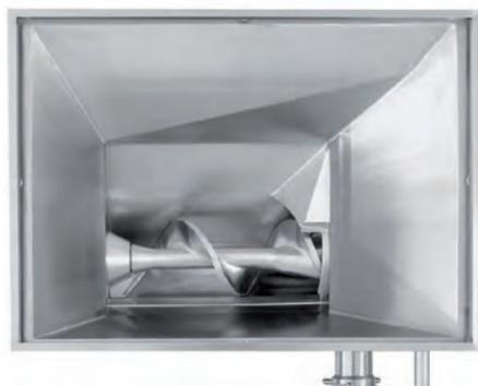
■ Principe du hachoir à angle: vis d'amenée + vis de hachage perpendiculaires
