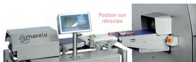
■ Tapis de sortie rétractable - Option (RO = Retractable Outfeed)
