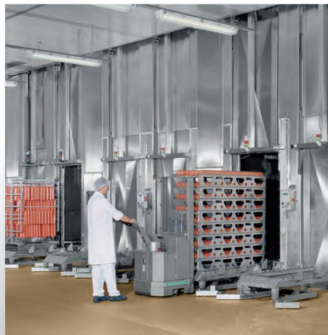
■ Cellule semi-continue - Dépose extérieure surélevée
