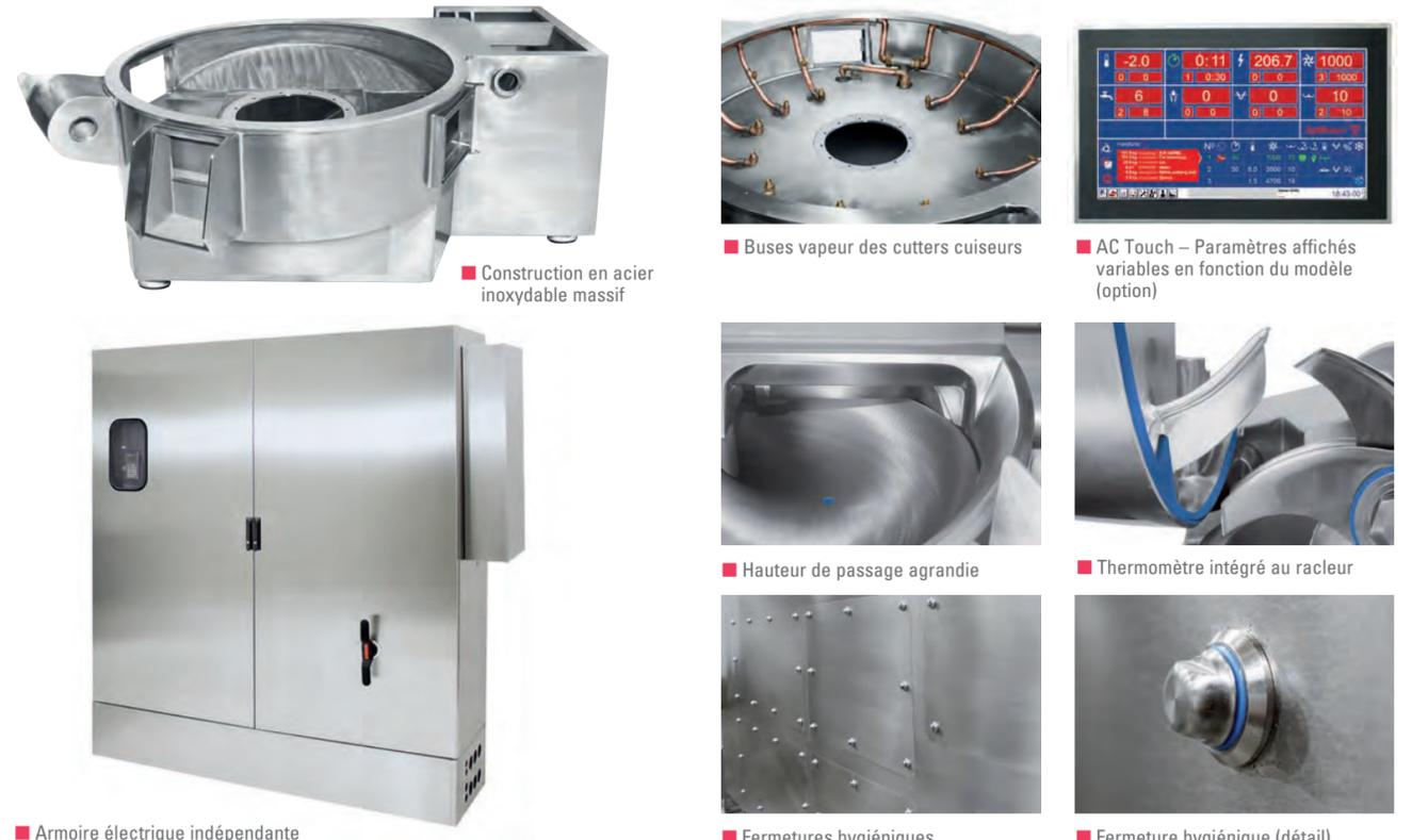
■ Construction en acier inoxydable massif    ■ Buses vapeur des cutters cuiseurs    ■ AC Touch – Paramètres affichés variables en fonction du modèle (option)    ■ Hauteur de passage agrandie    ■ Thermomètre intégré au racleur    ■ Armoire électrique indépendante    ■ Fermetures hygiéniques    ■ Fermeture hygiénique (détail)
