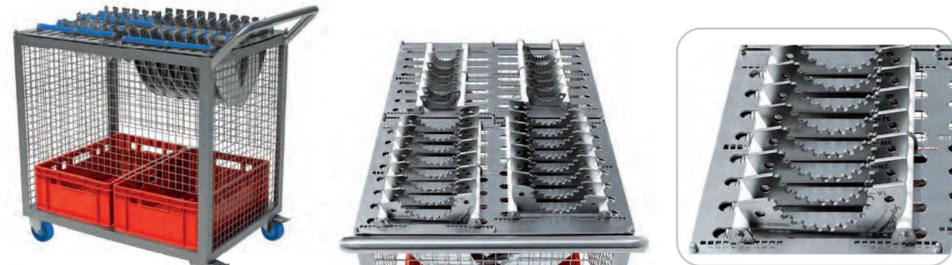
■ Chariot de rangement des couteaux    ■ Porte-couteaux réglables en largeur    ■ Barres de réglage en largeur
