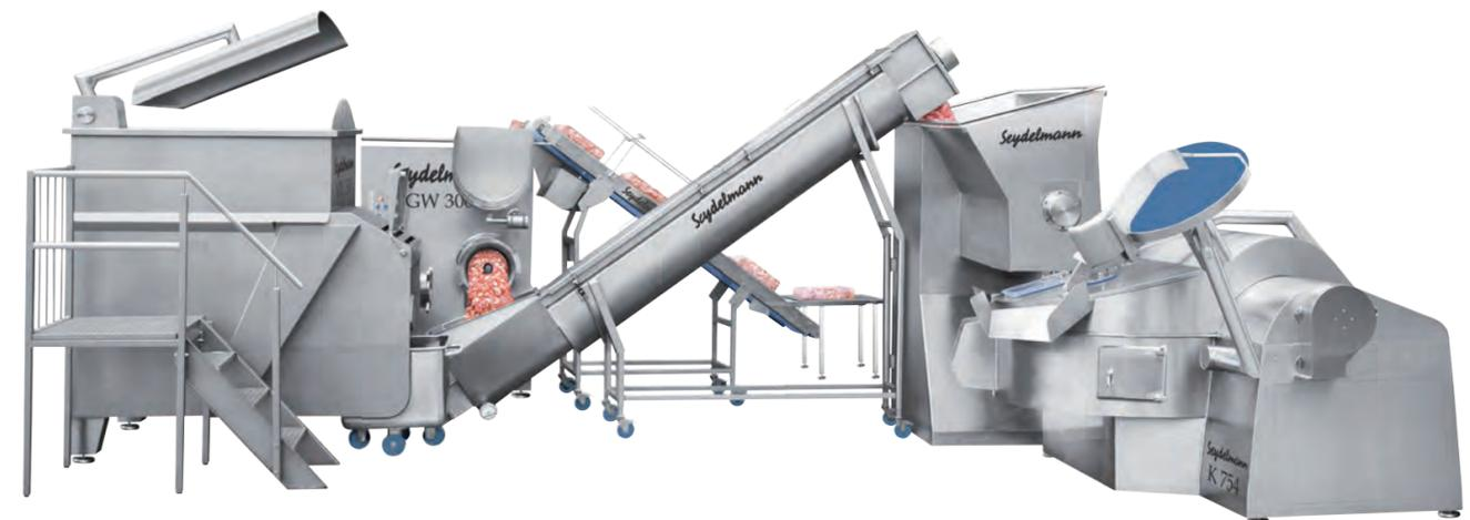
■ **Ligne de préparation automatisée** - Composée d'un hachoir direct GW 300 pour viandes congelées en blocs équipé d'un tapis à tasseaux, d'un hachoir mélangeur MRU 1300 équipé en cryogénie, d'une vis de transfert, d'un stockage tampon prévu pour le remplissage rapide de la Cutter 750 l AC8
