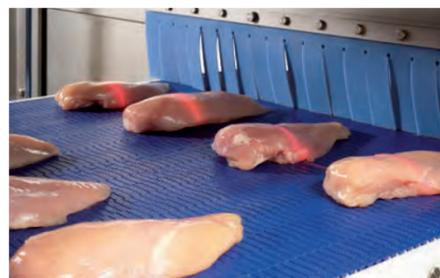
■ Scan des produits en 3D par numérisation avec 3 caméras placées à 120° (scan à 360°)
