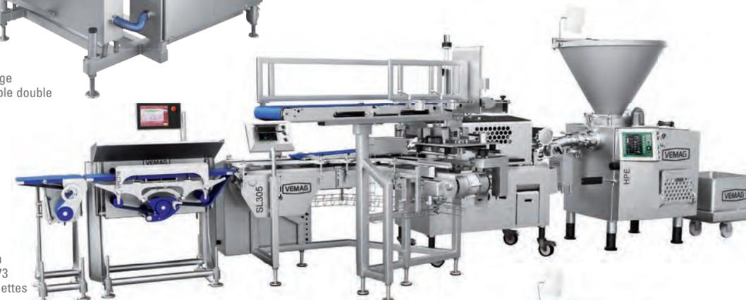
■ Ligne de production de boulettes AML273 avec mise en barquettes automatique
