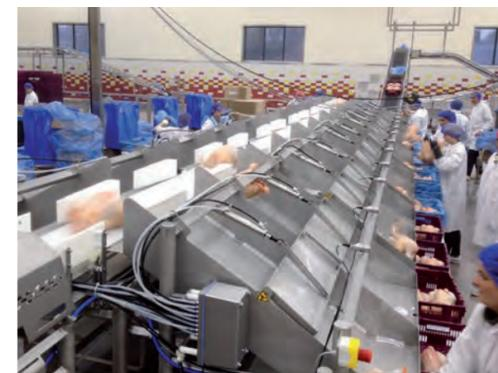
■ Système de triage classique avec tapis d'alimentation, pesage dynamique et tapis de triage
