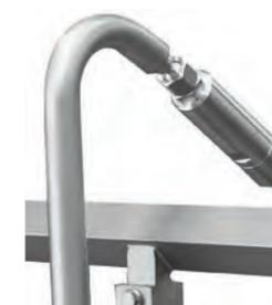
■ Contrôle laser du remplissage de la trémie à 3 niveaux
