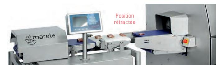
■ Tapis de sortie rétractable - Option (RO = Retractable Outfeed)
