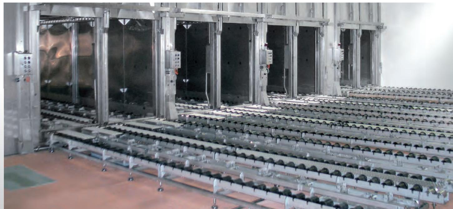
■ Stockage tampon en sortie, sur transrouleurs pour chariots sans roue
