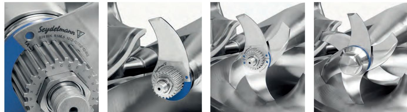
■ Tête de couteaux "S24" sans équilibrage    ■ Montage individuel et décalé des 2 premiers couteaux (aspiration du flux de viande pour éviter les bouchages)    ■ Montage par paire des 3<sup>e</sup> et 4<sup>e</sup> couteaux + de 5<sup>e</sup> et 6<sup>e</sup>    ■ Tête de couteaux complète
