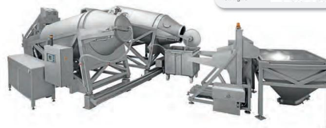
■ **Ligne automatique BBV** - Ligne de salage de jambon entièrement automatisée depuis l'injection jusqu'à la cuisson
