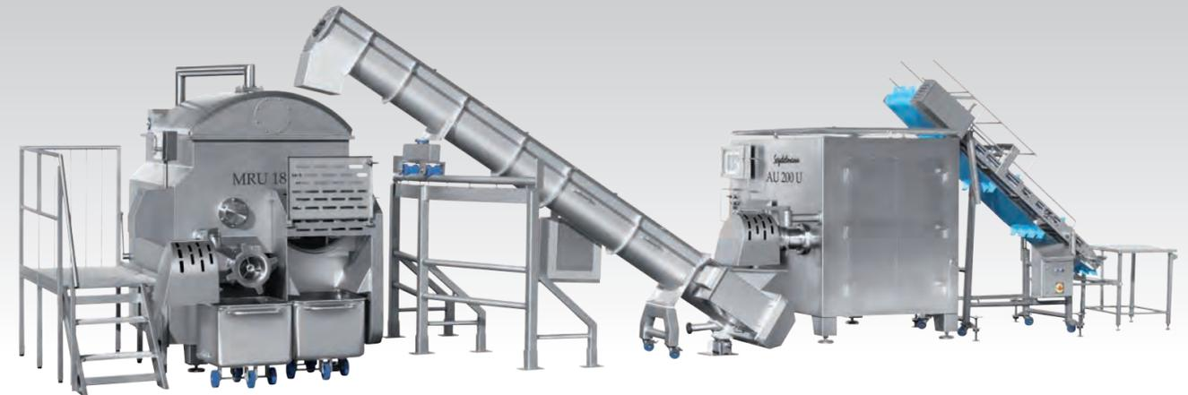
■ **Ligne de préparation automatisée** - Composée d'un tapis à tasseaux, d'un hachoir universel pour viandes fraîches et congelées en blocs AU 200 U, d'une vis de transfert pivotante et d'un hachoir mélangeur MRU 1800 équipé en cryogénie (injection basse d'azote liquide)
