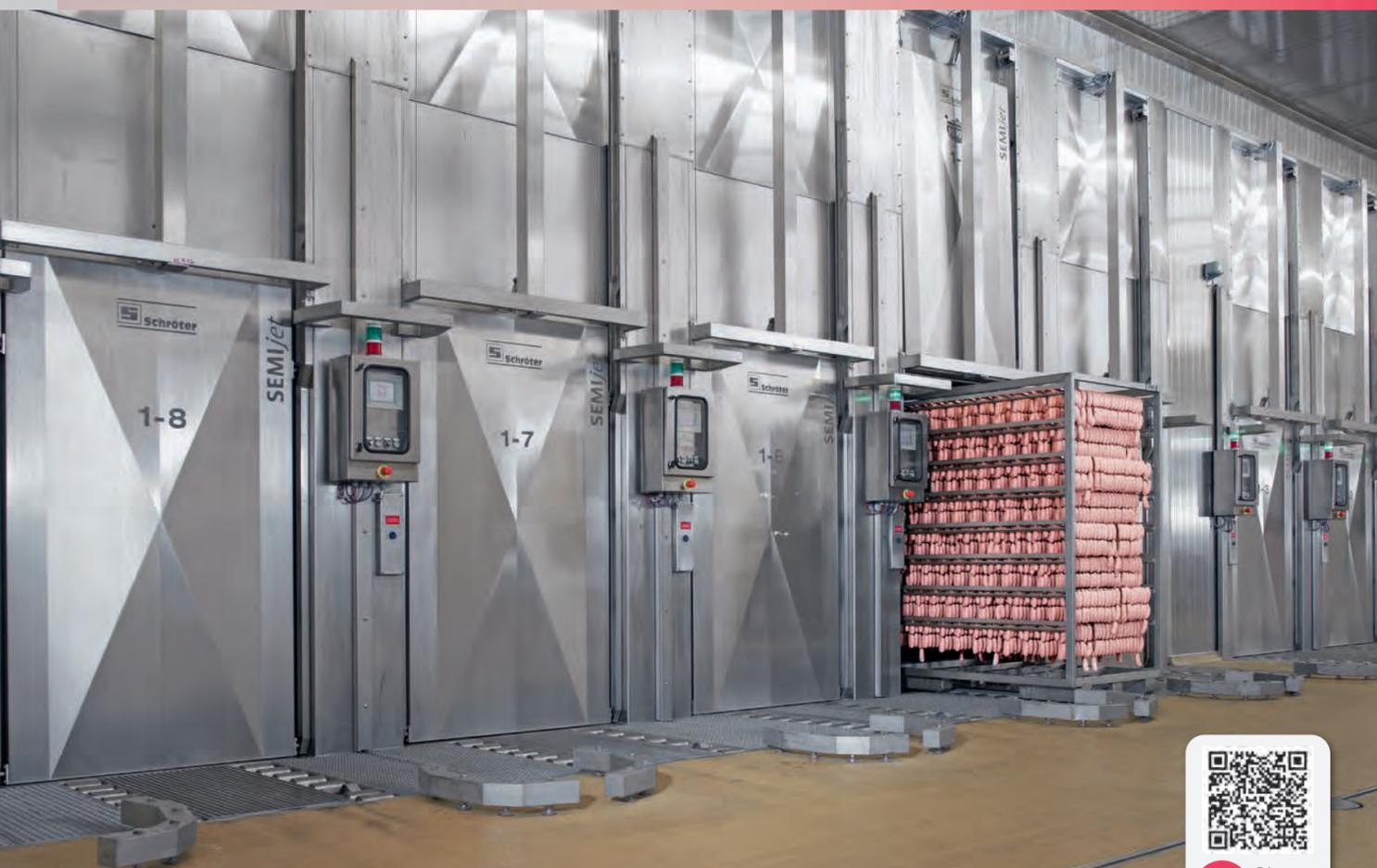
■ Cellule semi-continue - Dépose extérieure intégrée au sol
