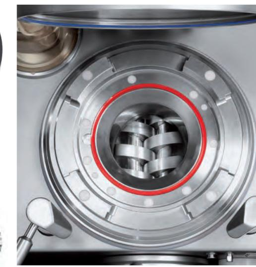
■ Double vis en place (trémie relevée)
