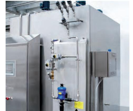
■ Dispositif de nettoyage avec dosatron (option)
