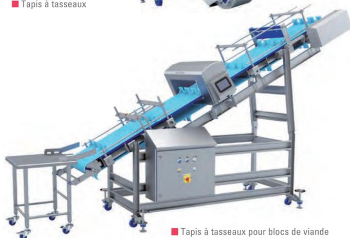
■ Tapis à tasseaux pour blocs de viande congelée avec table de dépose et détecteur de métaux
