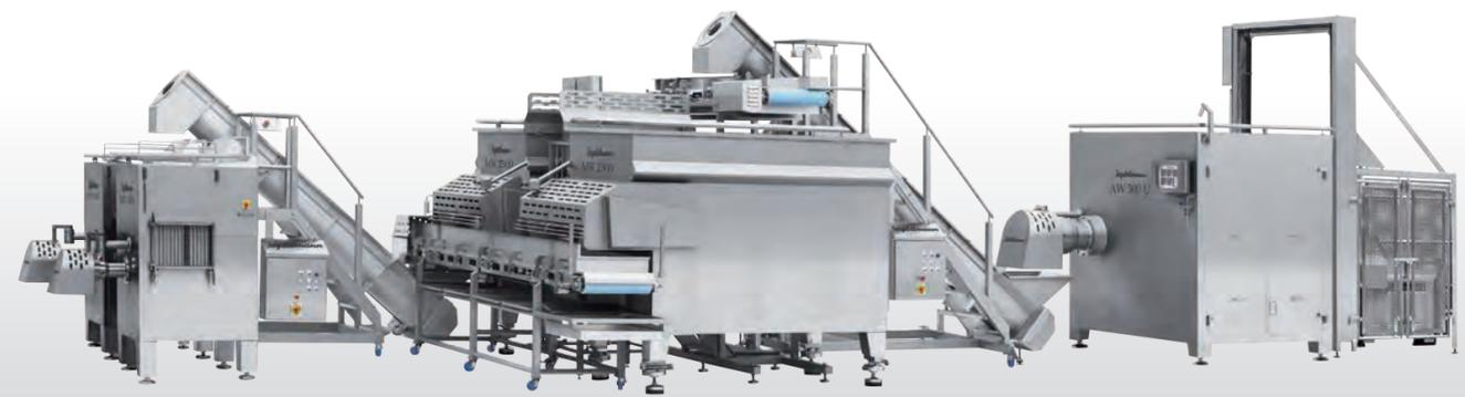
■ **Ligne de préparation automatisée** - Composée d'un hachoir universel AW 300U équipé d'un élévateur à bacs 1000 l, d'une vis de transfert, de deux mélangeurs MR 2500, d'un tapis de transfert, d'une vis de transfert pivotante et de deux hachoirs mélangeurs MU 200
