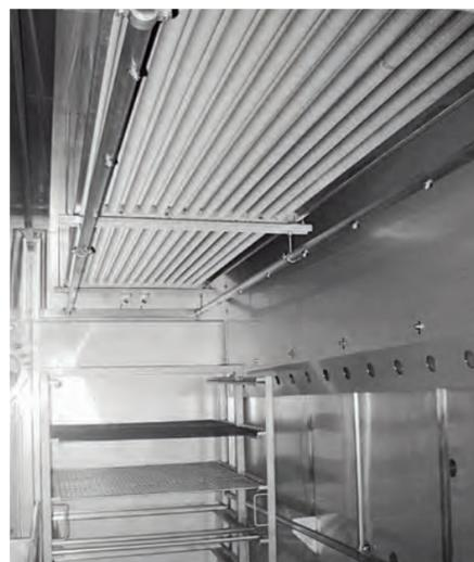
■ Batterie froide inox centrale, buses de douchage, ouïes de ventilation, tubes de protection
