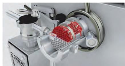
■ Dénerveur 813 (schéma de principe)
