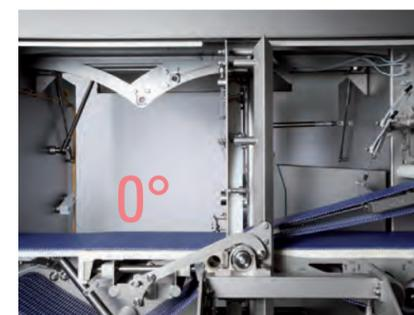
■ Changement d'angle manuel avec ajustement automatique de l'écartement des tapis d'amenée et d'évacuation
