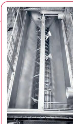
■ Vue du dessus sur le dévôteur et la vis de transfert
