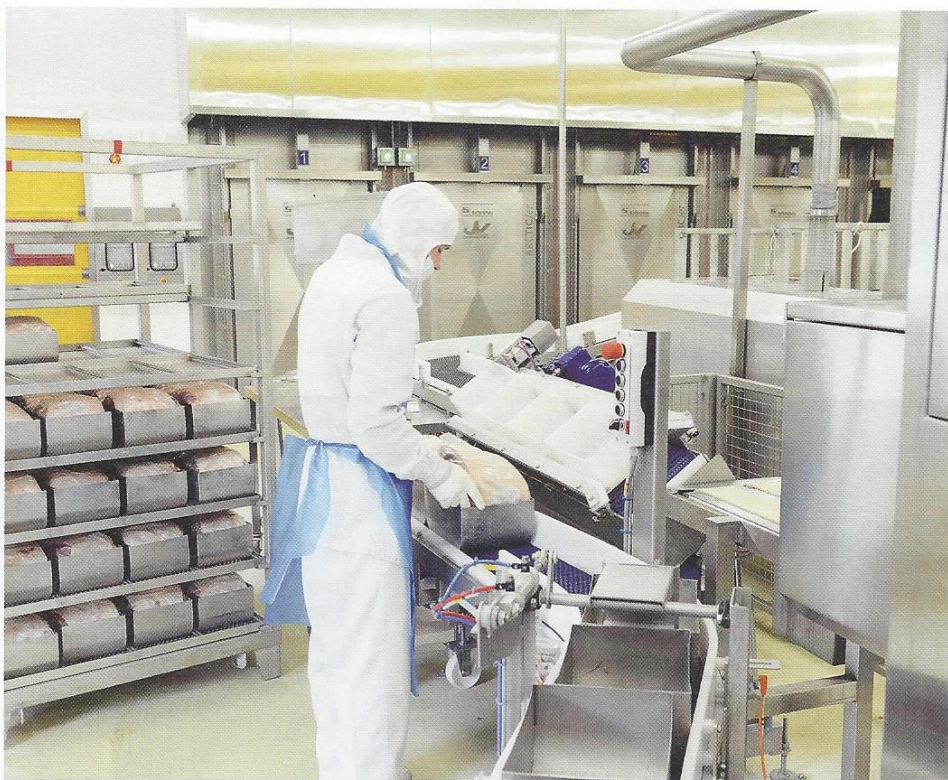
La nouvelle ligne MCA de moulage des jambons bénéficie d'améliorations en termes d'ergonomie (postes réglables) et de réduction du bruit (moules en polyéthylène haute densité).
