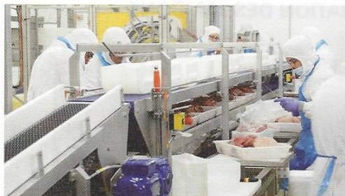
Un système de crémaillère permet de régler la hauteur de poste.
