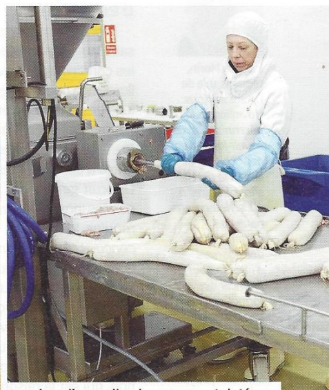
Les deux lignes d'embossage sont dotées chacune d'un poussoir polyvalent sous-vide Handtmann VF 620.
