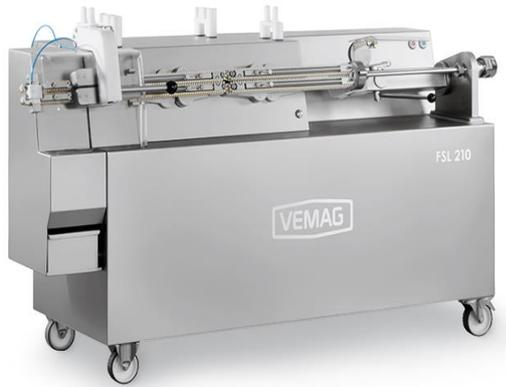
Ce module de calibration, de torsadage et de séparation d'occasion JV la Française / Vemag est adapté pour tous types de saucisses (en boyau naturel, collagénique ou artificiel). Il permet le portionnement à longueurs constantes de saucisses de calibre 13 à 40 mm voire plus. Performant, il peut traiter jusqu'à 800 portions/min (en fonction du produit et des réglages). Facile d'entretien, il fonctionne en coordination avec un poussoir sous-vide VEMAG.
