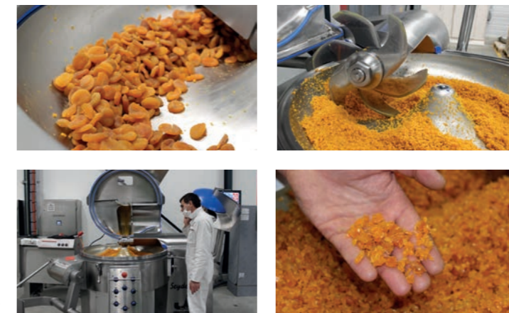
Broyage de fruits secs avec cutter, essais concluant avec un jeu de coupe S24 Type V
