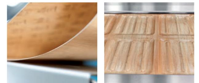
L'outil de chauffage peut être adapté pour obtenir un point de ramollissement adéquat selon la qualité du film utilisé.
