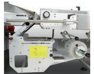
**Position inférieure :** la soudure se retrouve sur le dessus du produit pour des raisons esthétiques ou techniques liées à la composition du produit (exemple d'un saucisson avec ficelle : la ficelle ne risque plus d'être entraînée par les roues de scellage).
