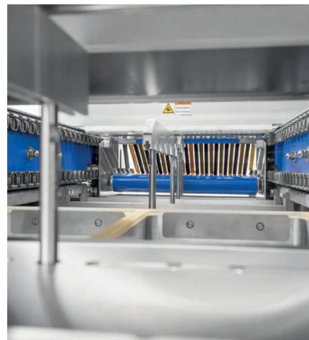
■ Moule de vide, réinjection de gaz et scellage
