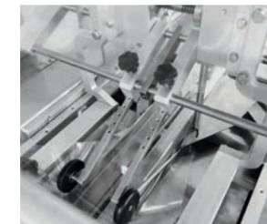
**Conformateur réglable :** grâce à des molettes de serrage, la modification des dimensions se fait rapidement (néanmoins, le serrage est moins précis).
