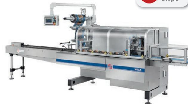
Notre ensacheuse Vela permet de conditionner vos produits sous atmosphère protectrice avec le procédé flowpack. L'insertion de gaz par balayage permet d'optimiser la conservation.
