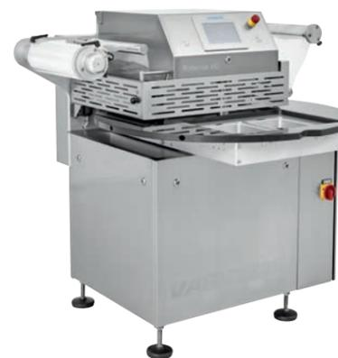
Notre operculeuse semi-automatique est équipée d'un système à double emplacement de barquettes. Elle doit son nom à sa table rotative : pendant que la machine scelle les barquettes, l'opérateur placé à l'avant de la machine peut retirer les barquettes operculées et en insérer immédiatement de nouvelles.
