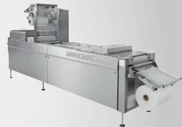
■ Thermoformeuse modulaire
