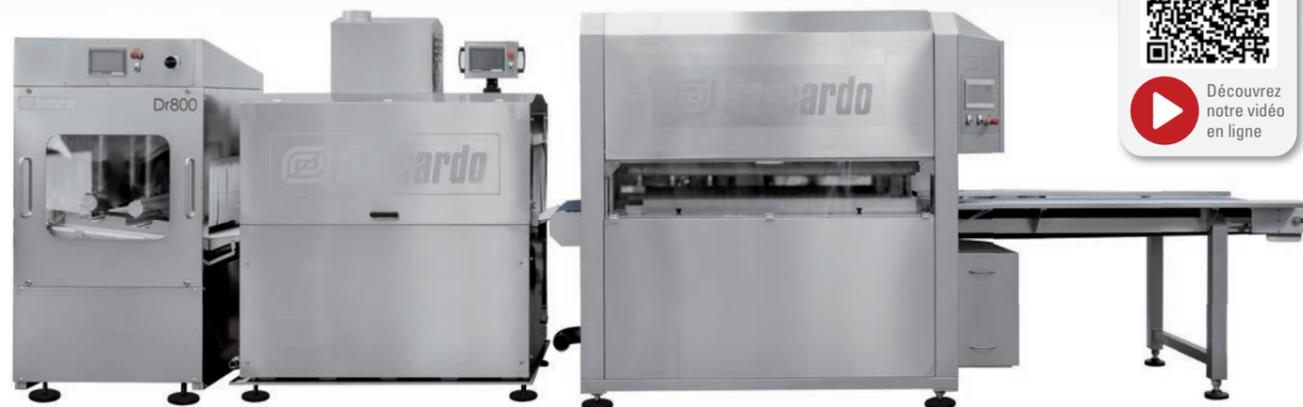
■ Ligne de conditionnement sous-vide automatique avec tunnel de rétraction par aspersion et assécheur
