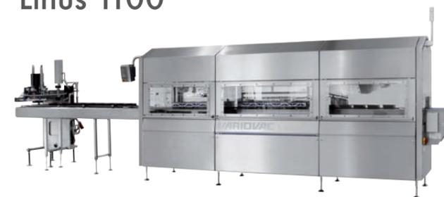
Notre operculeuse est entièrement automatisée pour toutes les barquettes existantes et à sceller. Elles peuvent être introduites dans la machine par un tapis et le transfert vers le poste de scellage se fait par un préhenseur spécifique dont le changement est simple et rapide. La longueur standard de la zone de chargement est de 1 200 mm et peut être étendue avec un module d'extension de 1 000 mm à 2 200 mm.
