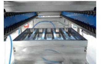
Le Rapid Air System® est **entièrement paramétrable** pour chaque programme, **selon la qualité des films utilisés** et la spécificité des outillages. Cette technologie de formage rapide est qualitative quelle que soit l'épaisseur du film utilisé.
