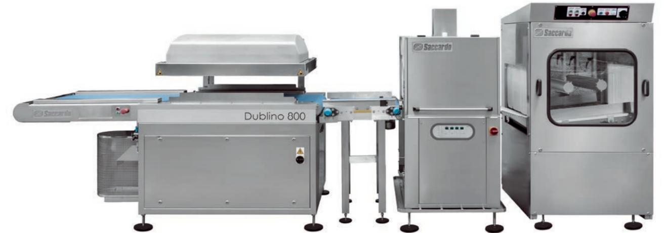
■ Ligne de conditionnement sous-vide automatique avec tunnel de rétraction à immersion et assécheur
