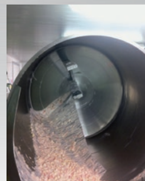
■ Qualité de vidage grâce au racleur de cuve
