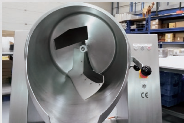
■ VSM 150 SC avec basculement manuel de la cuve
