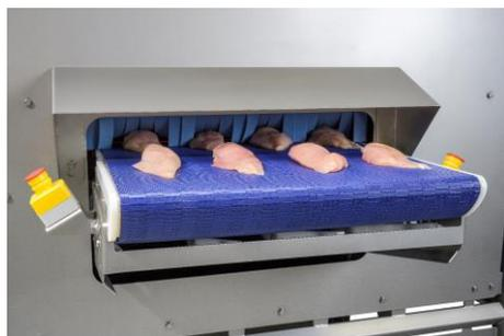
■ Module comprenant 2 stations de jet d'eau haute pression (extension possible jusqu'à 3 modules)
