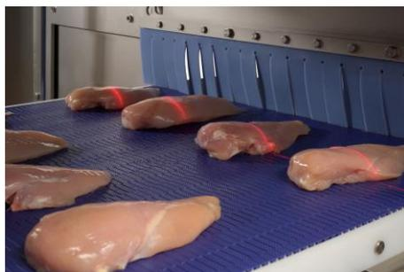
■ Scan des produits en 3D par numérisation avec 3 caméras placées à 120° (scan à 360°)
